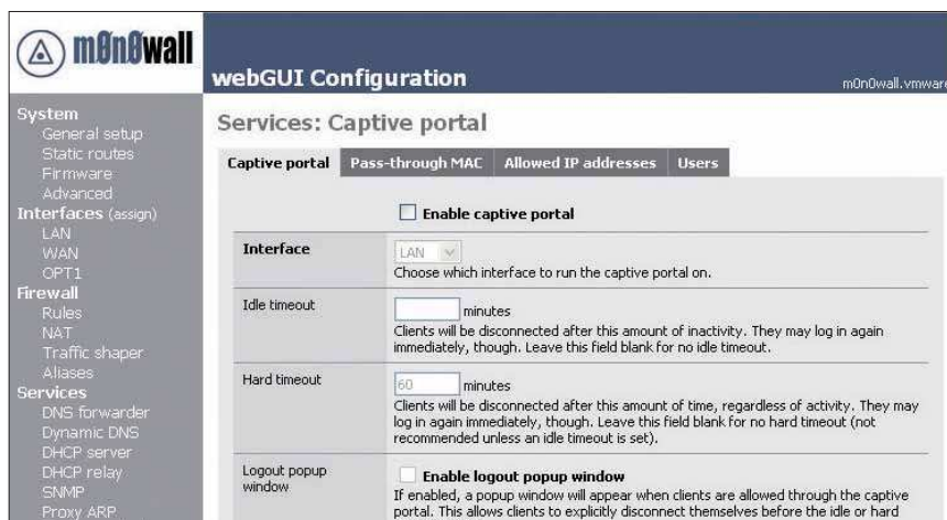
Monowall enthält ein Captive-Portal, mit dem die Firewall zusätzlich als Wireless-Access-Point für drahtlose Verbindungen genutzt werden kann
